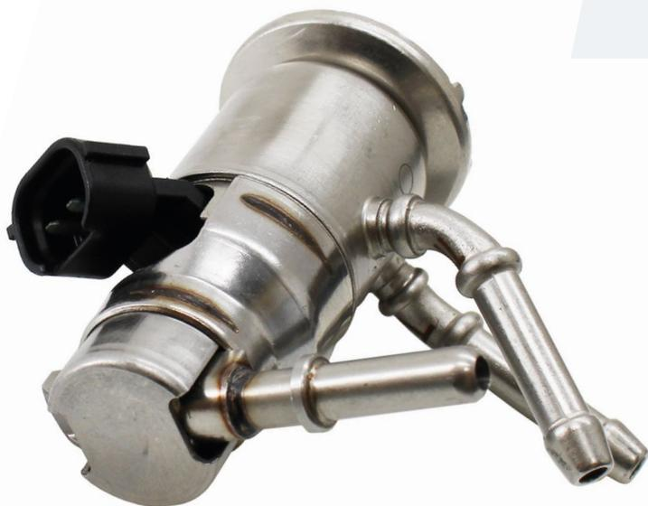
Le système SCR (Selective Catalytic Reduction) est un dispositif de réduction des émissions présent sur de nombreux véhicules diesel modernes. Il utilise un liquide appelé **"liquide d'urée"** (une solution contenant 32,5 % d'urée) pour **diminuer les émissions d'oxydes d'azote (NOx) des moteurs diesel**.
